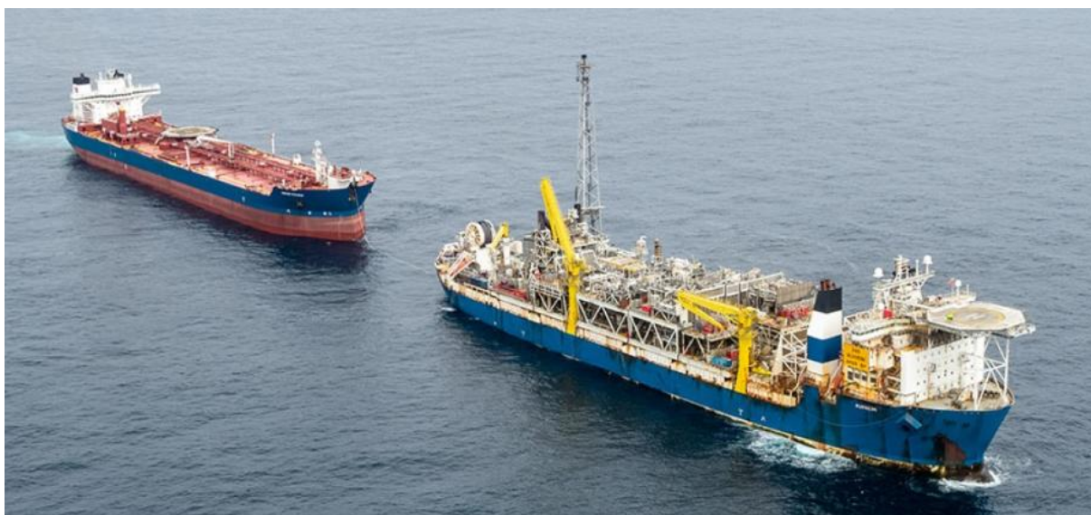
Figur 2-6. Alvheim FPSO under lossing til bøyelaster.
