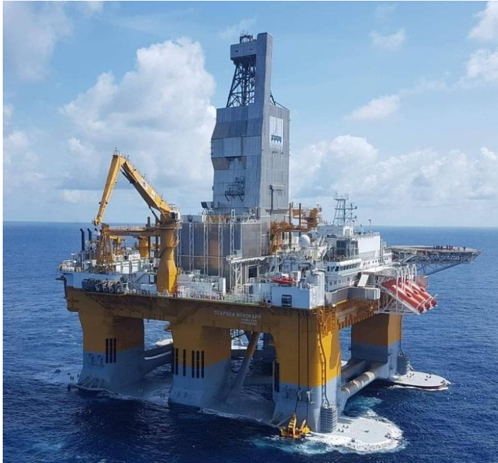
Figur 2-6. Den halvt nedsenkbare boreriggen Deepsea Nordkapp er planlagt benyttet til boreoperasjonene på Kjøttkake-funnet.
