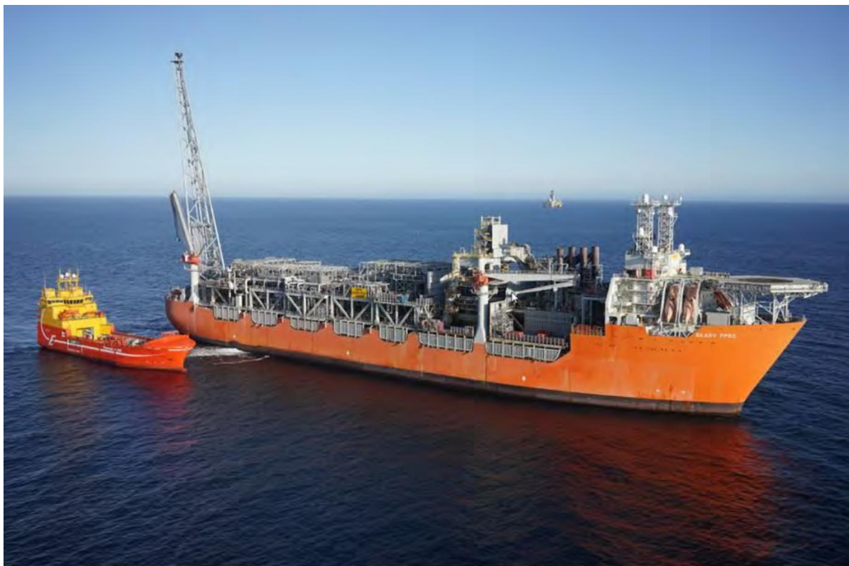
Figur 2-6. Skarv produksjons- og lagerskip (FPSO).
