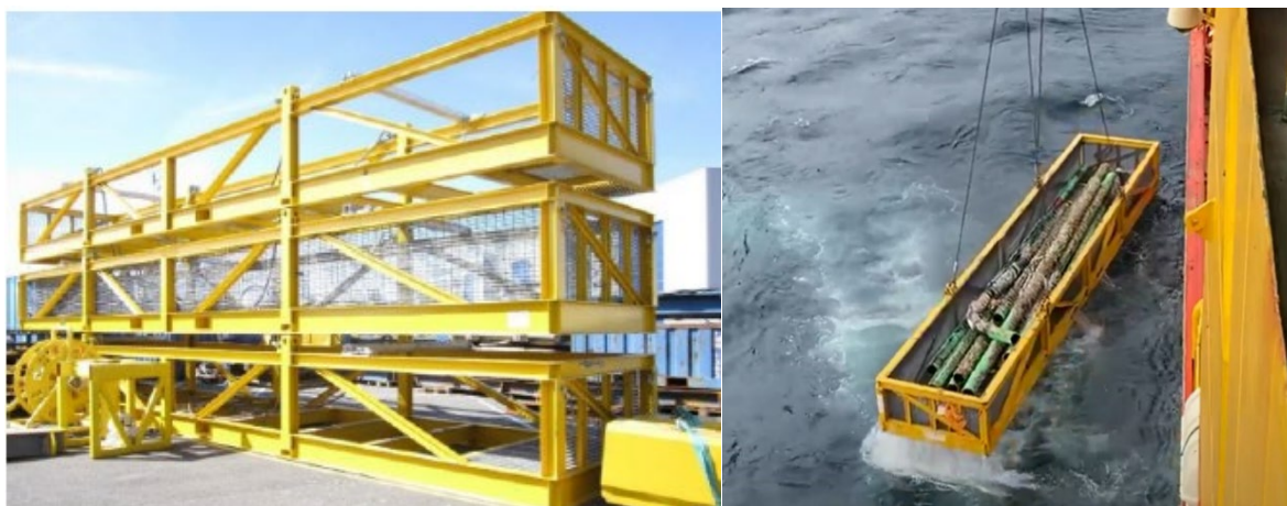
Figur 2-18. Løftekorger for opptak og transport av rørseksjoner. Kilde: DeepOcean.
