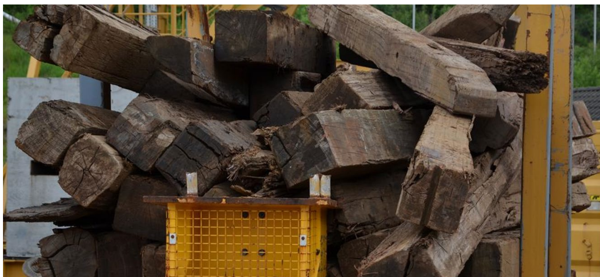
Figur 7-5. Eksempel på trevirke fra hogging av petroleumsinnretning.
