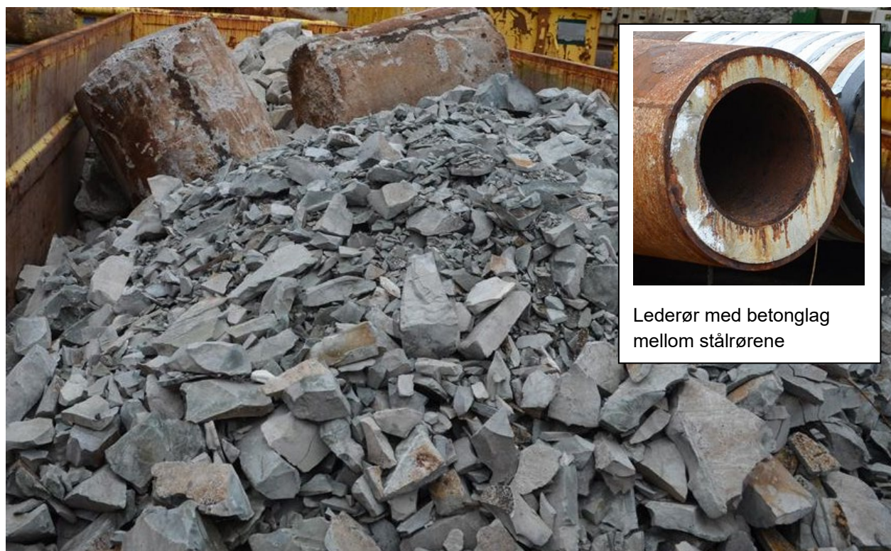
Figur 7-6. Eksempel på avfall av betong/lettbetong fra hogging av plattformer. Lederør innfelt.
