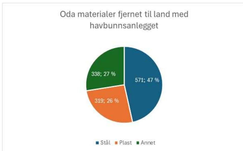
Figur 7-2. Fordeling av materialer i havbunnsanlegget med tilhørende deksler mv. (tonn og prosentfordeling). «Annet» er i hovedsak betong.
