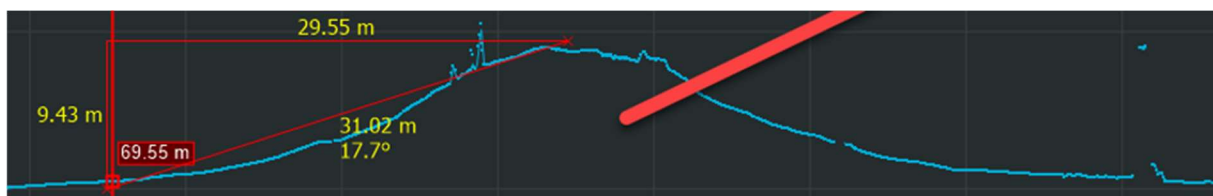
Figur 2-5. Fasong og utbredelse av borekakhauget under/ved Ula D. Tverrsnitt nederst.
