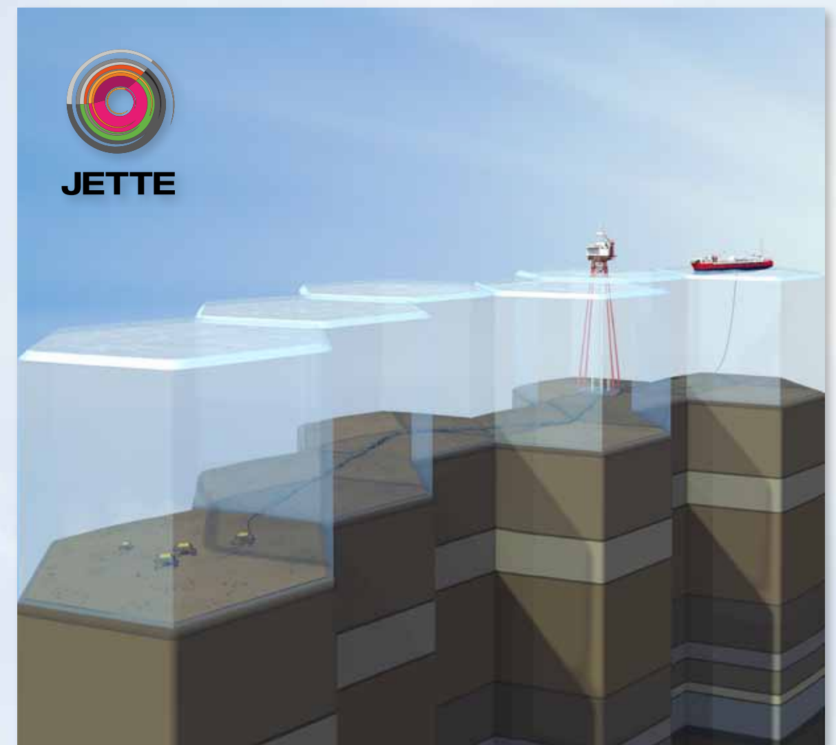
Jette bygges ut med to satellitbrønner som knyttes til Jotun B via en seks kilometer lang rørledning. Produksjonen fra Jotun og Jette blandes på Jotun B, og sendes sammen til Jotun A (FPSO) for prosessering og eksport.
