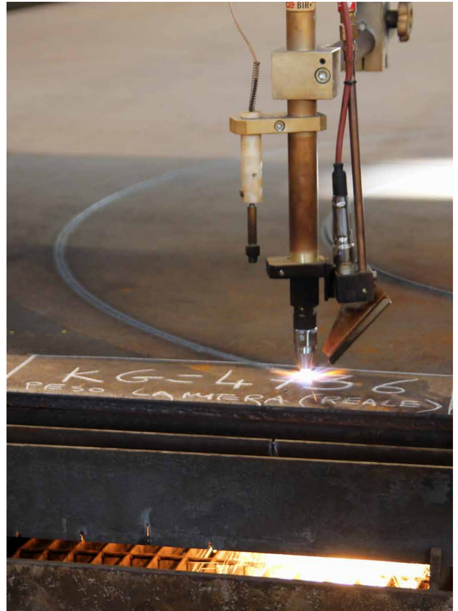
Laser gjer jobben: 4. november 2013 vart det første stålet til understellet på Ivar Aasen-plattform kutta, på Saipem-verftet i Arbatax på Sardinia. Foto: Det norske
