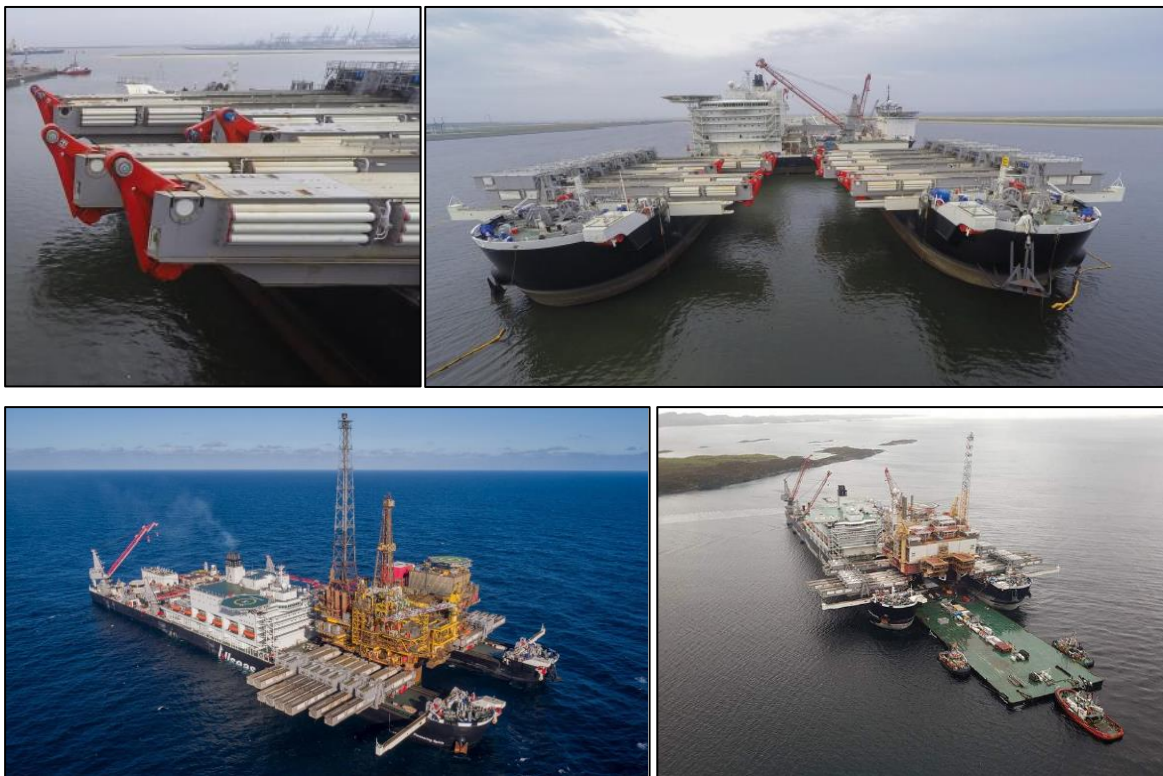
Figur 2-8. Løftearmer (øverst venstre), fartøykonfigurasjon før løft (øverst høyre), fjerning av overbygning - her Brent Delta (nedre venstre) og overføring til lekter - her Yme (nedre høyre). Bilder fra Allseas.
